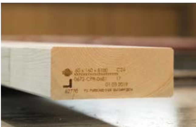
Holzkennzeichnung mit CO 2 Laser
