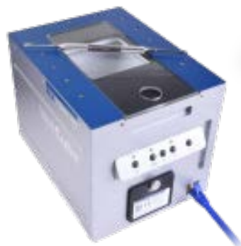
REA VeriCube DPM mit diffuser Ausleuchtung (für UDI Codeprüfung)
