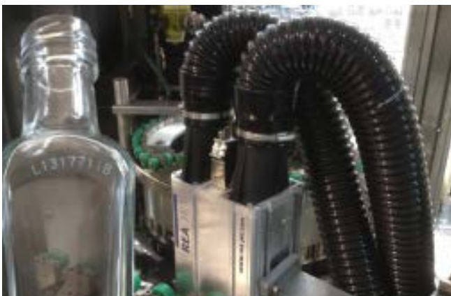
Glaskennzeichnung mit CO 2 Laser IP65
