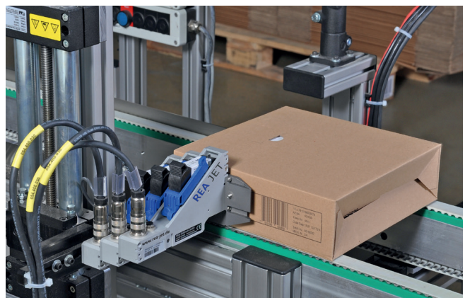
Etiketteneinsparung durch HR Direktdruck auf Kartonagen
