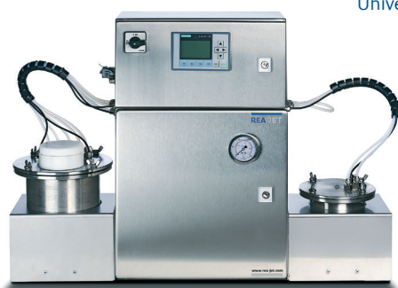
REA JET Tintenversorgung TV-PP 4,5 Liter (AFS) mit automatischer Spülfunktion
