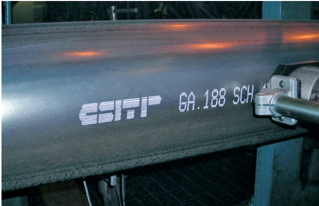
Kennzeichnung von Rohren (Stahl, Kunststoff etc.)
