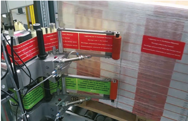
Applizieren von Etiketten auf Schrumpfhäuben
