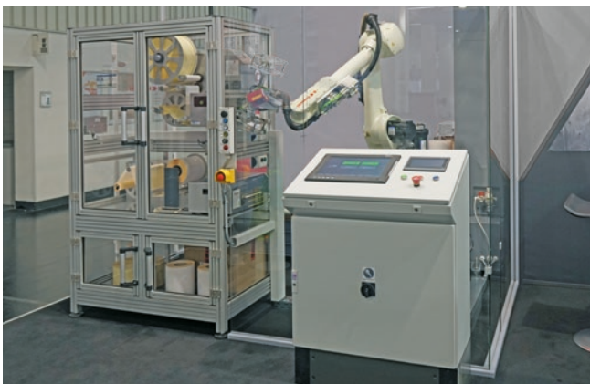
Roboterzelle mit 1:1 Vollfarbdruck und Spendemodul
