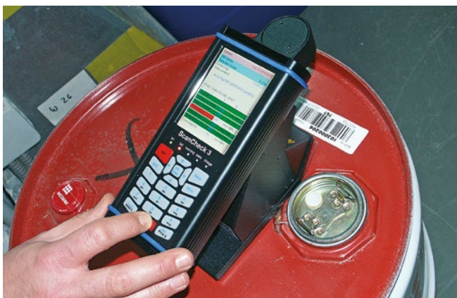
Prüfung von Barcodes auf Blechfässern
