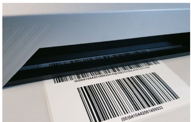
Prüfen von breiten Transportetiketten
