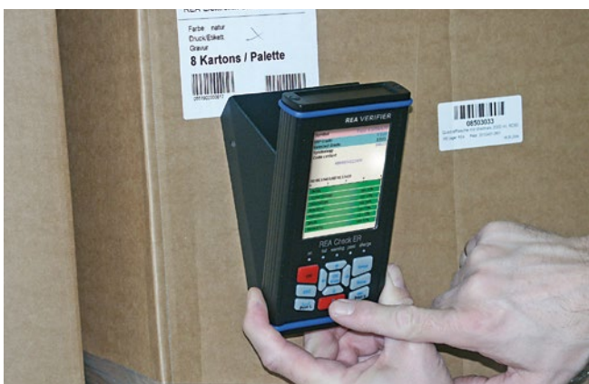
Mobile Barcode Prüfung vor Ort
