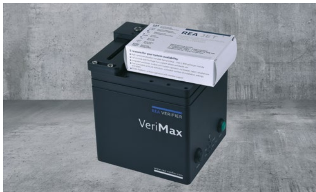
REA VeriMax mit aufgelegtem Prüfling
