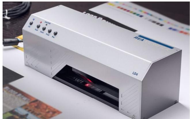
Messung von Druckbögen in der Fertigung
