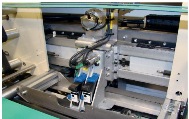
HR pro OEM integriert in Kuvertiermaschine
