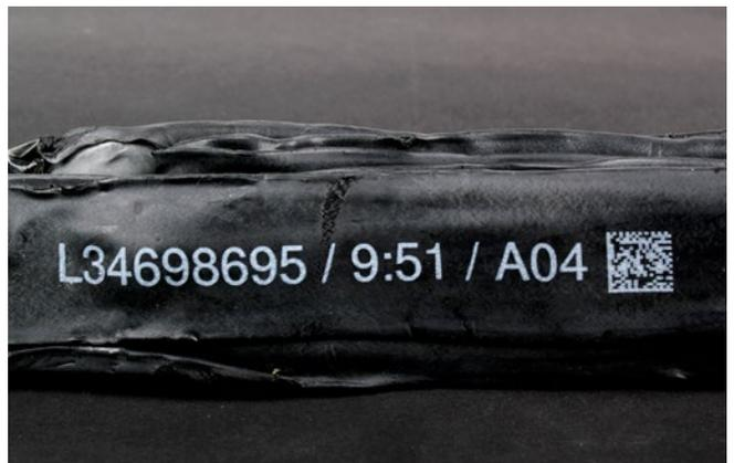
Hochauflösend aufgedruckter 2D und alphanumerischer Code auf nicht vulkanisiertem Gummi
