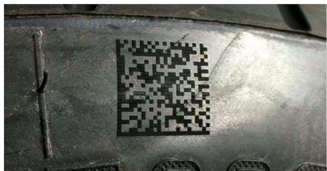
Unverlierbare Lasermarkierung auf fertigem Reifen mit 2D-Code
