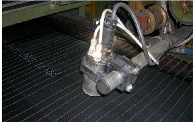
Kennzeichnung von Textilcord mit Produktionscode
