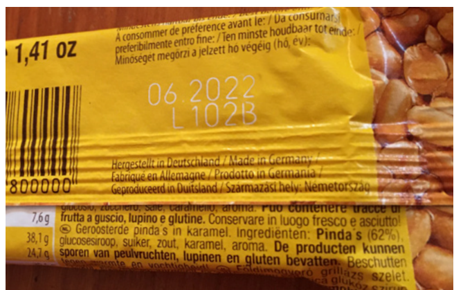
Farbabtrag auf Schlauchbeutelverpackungen (REA JET CL Laser)
