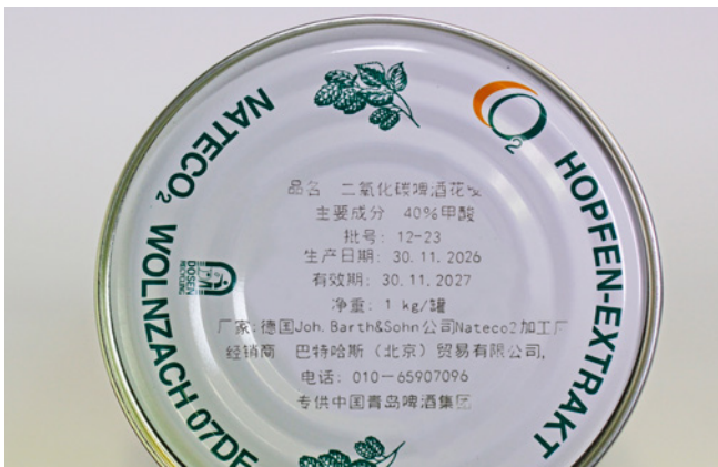
Weißblechdosenbeschriftung durch Farbabtrag (REA JET CL)
