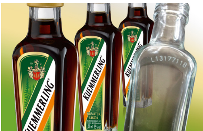
Glasflaschenkennzeichnung (REA JET CL Laser)
