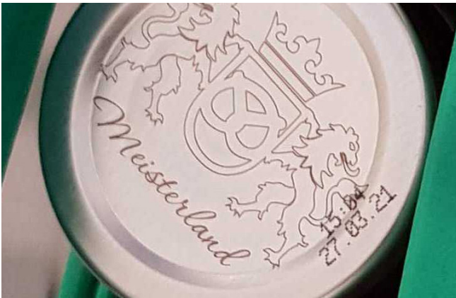
MHD Kennzeichnung von Schraubdeckel (REA JET SC 2.0)
