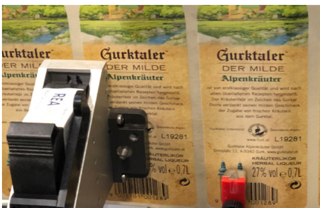
Beschriftungen von Flaschenetiketten (REA JET HR)
